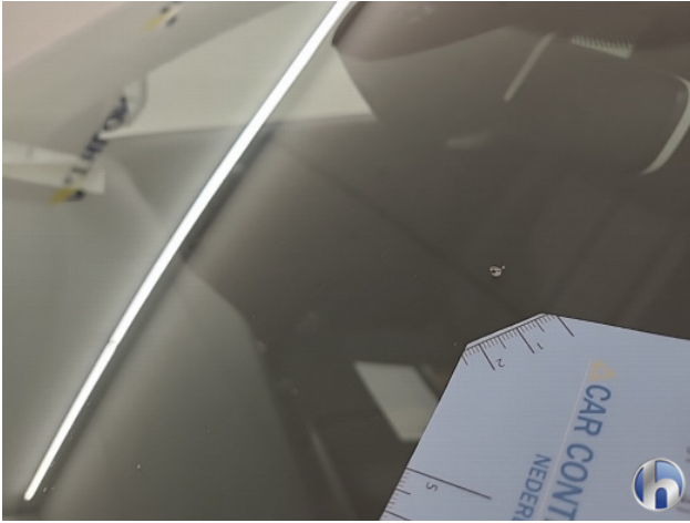
1. Diverse Gebruikssporen - Aanvaardbaar
