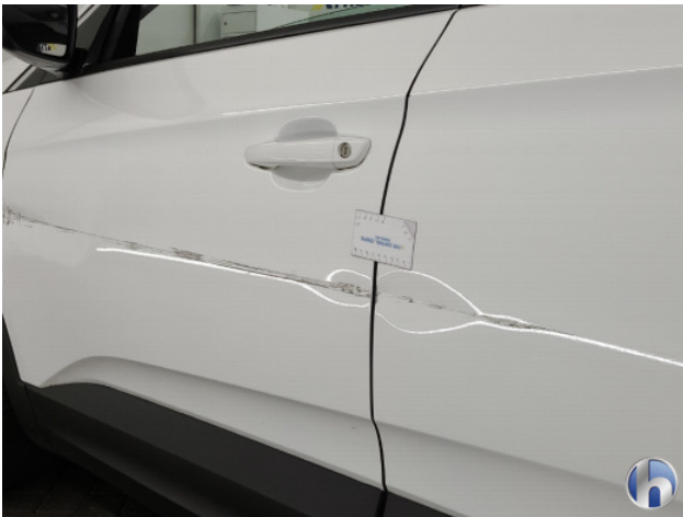
1. Portier voor - links Deuk/deuken - Herstellen
