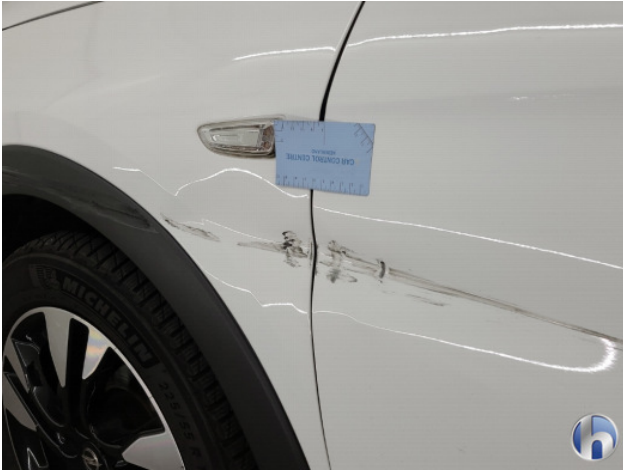
1. Portier voor - links Deuk/deuken - Herstellen
