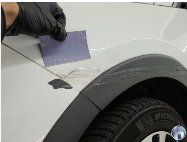
1. Portier voor - links Deuk/deuken - Herstellen
