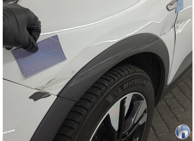
1. Portier voor - links Deuk/deuken - Herstellen
