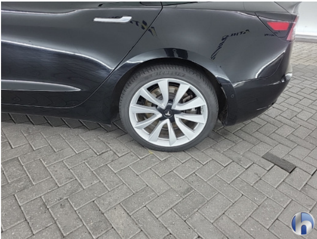
1. Velg achter - links Beschadigd - Herstellen
