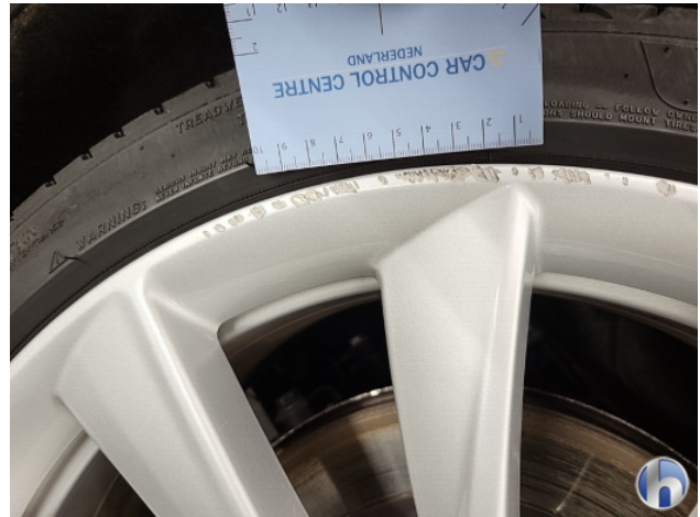
1. Velg achter - links Beschadigd - Herstellen
