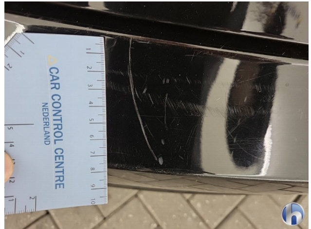
1. Achterbumper Gebruikssporen - Aanvaardbaar
