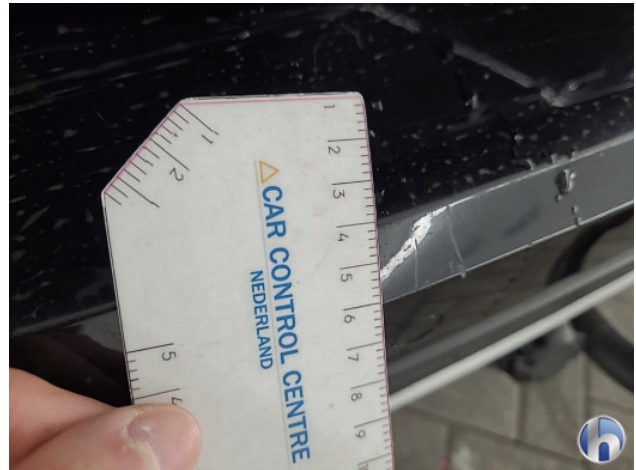
1. Achterbumper Gebruikssporen - Aanvaardbaar
