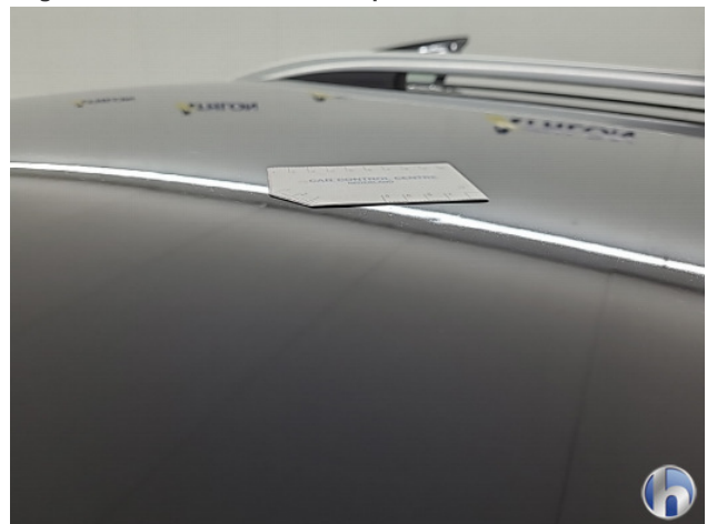
3. Dak Hagelschade - Herstellen zonder spuiten
