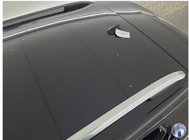
3. Dak Hagelschade - Herstellen zonder spuiten
