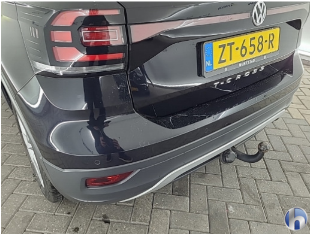
1. Achterbumper Gebruikssporen - Aanvaardbaar
