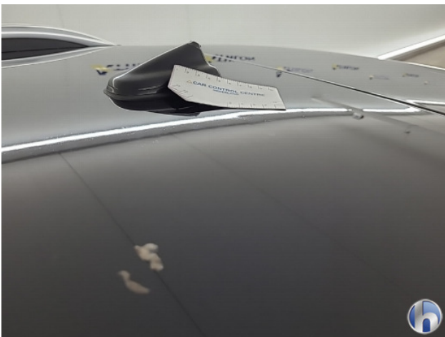
3. Dak Hagelschade - Herstellen zonder spuiten
