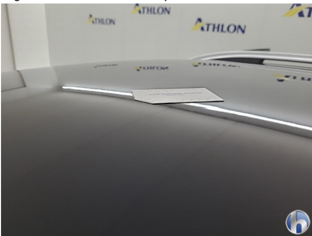
3. Dak Hagelschade - Herstellen zonder spuiten
