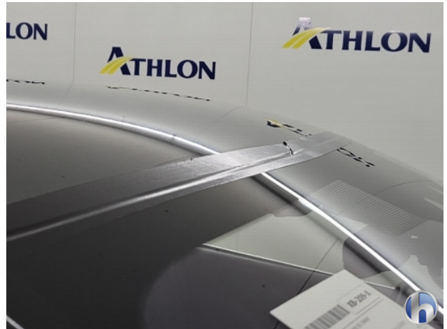
1. speling op de vooruit Gebruikssporen - Aanvaardbaar
