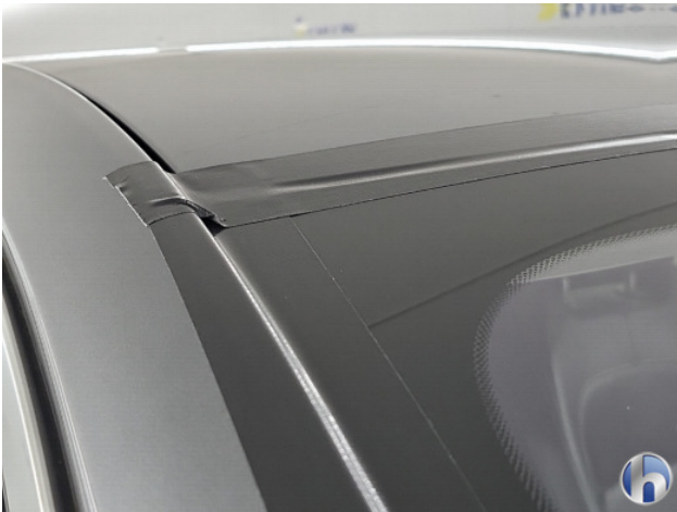
1. speling op de vooruit Gebruikssporen - Aanvaardbaar
