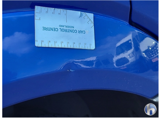
1. diverse Gebruikssporen - Aanvaardbaar
