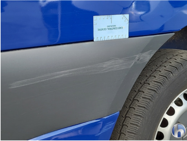
1. diverse Gebruikssporen - Aanvaardbaar
