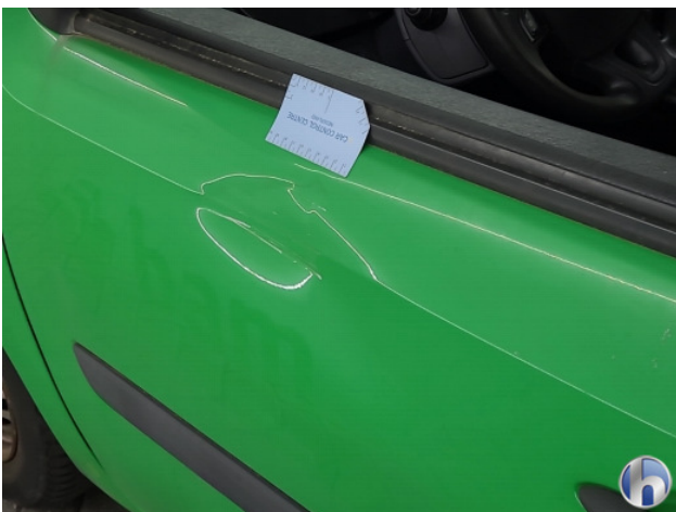
3. Portier voor - links Deuk/deuken - Herstellen
