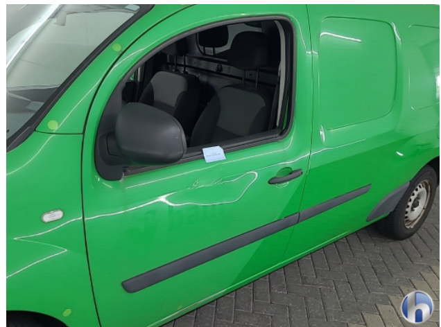
3. Portier voor - links Deuk/deuken - Herstellen
