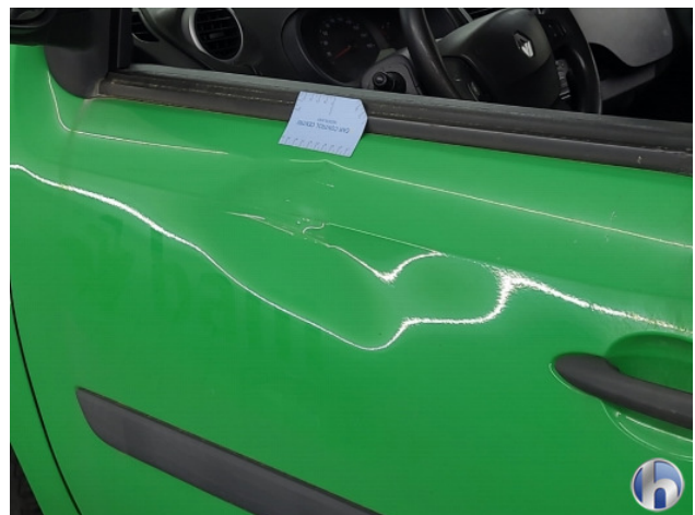
3. Portier voor - links Deuk/deuken - Herstellen
