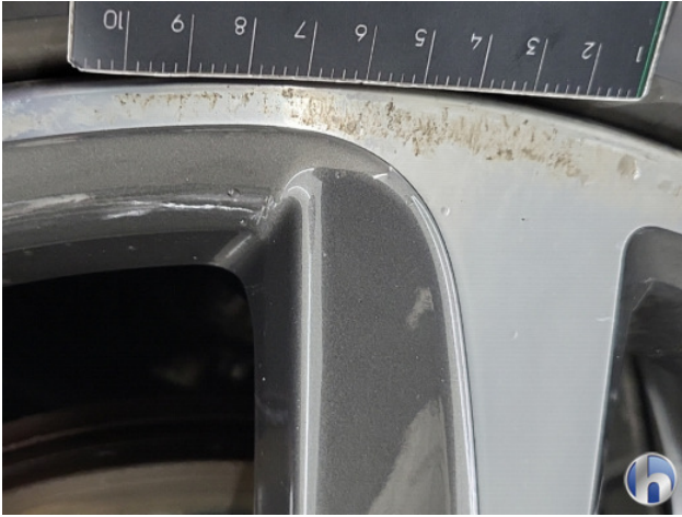
1. diverse Gebruikssporen - Aanvaardbaar
