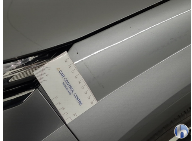
1. Diverse Gebruikssporen - Aanvaardbaar
