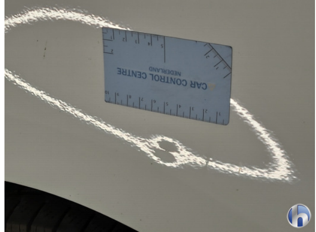
1. diverse Gebruikssporen - Aanvaardbaar
