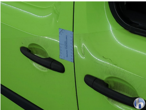
2. Portier voor - rechts Deuk/deuken - Herstellen
