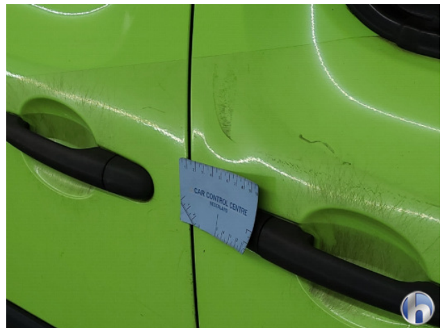
2. Portier voor - rechts Deuk/deuken - Herstellen
