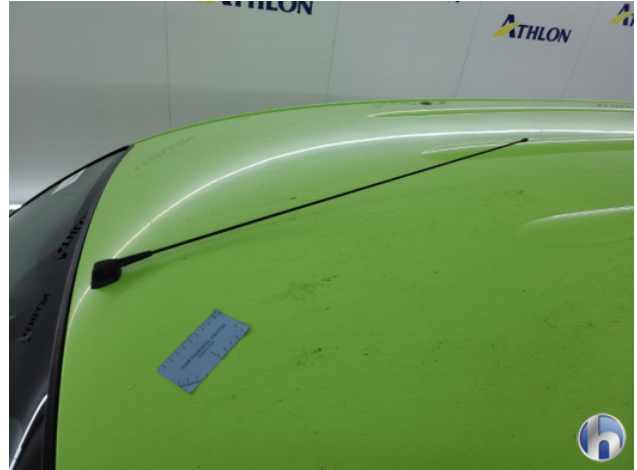
4. hagelschade Deuk/deuken - Herstellen zonder spuiten
