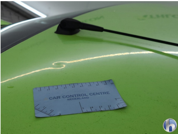
4. hagelschade Deuk/deuken - Herstellen zonder spuiten
