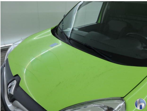
4. hagelschade Deuk/deuken - Herstellen zonder spuiten
