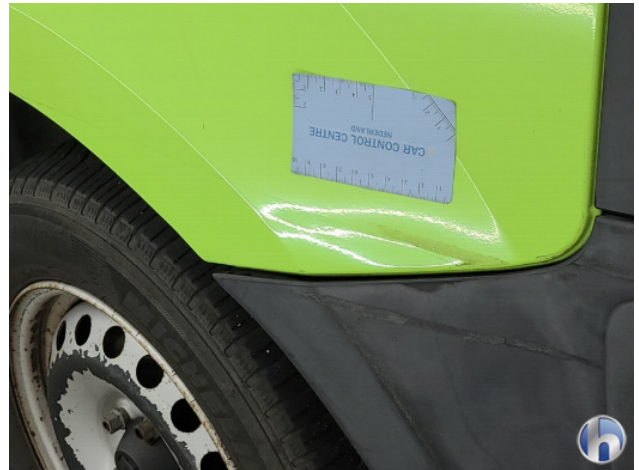
1. Zijwand - achter - Links Deuk/deuken - Herstellen
