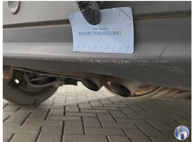
1. Achterbumper Gebruikssporen - Aanvaardbaar
