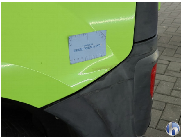
1. Zijwand - achter - Links Deuk/deuken - Herstellen
