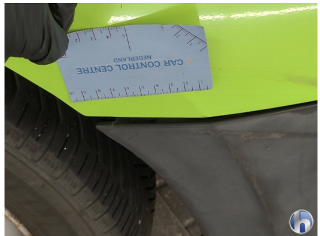
1. Zijwand - achter - Links Deuk/deuken - Herstellen
