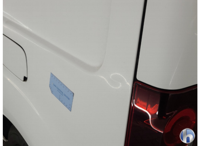
1. Zijwand - achter - Links Deuk/deuken - Herstellen zonder spuiten
