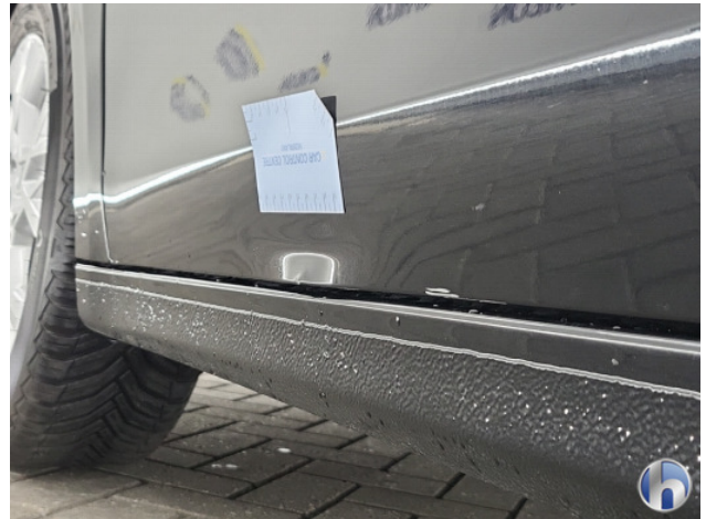
1. Portier voor - links Gedeukt - Herstellen
