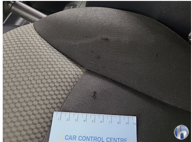
1. Stoel - voor - links: zitting Beschadigd - Vernieuwen
