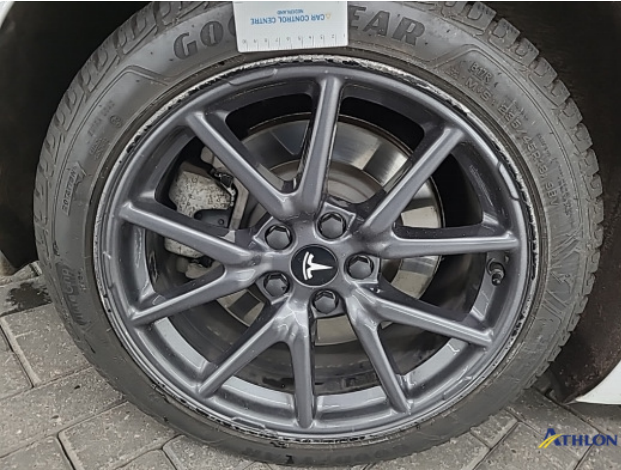
1. meerdere velgen Beschadigd
