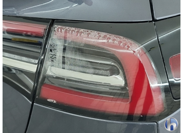
1. vocht achterlicht Beschadigd - Vernieuwen
