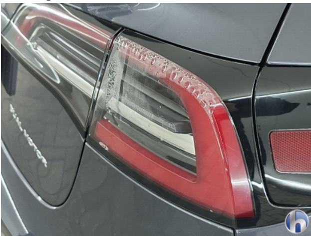
1. vocht achterlicht Beschadigd - Vernieuwen
