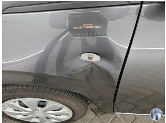
1. diverse schades Gebruikssporen - Aanvaardbaar
