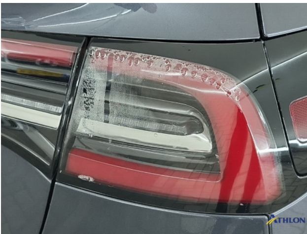
1. vocht achterlicht Beschadigd
