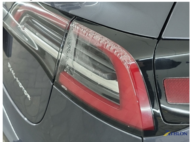
1. vocht achterlicht Beschadigd
