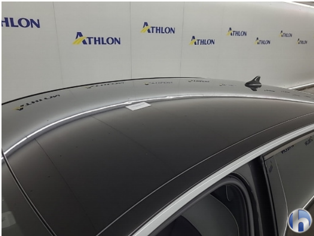
1. Dak Hagelschade - Herstellen zonder spuiten
