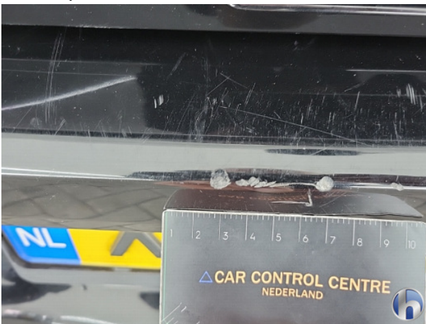
1. Achterbumper Gebruikssporen - Aanvaardbaar
