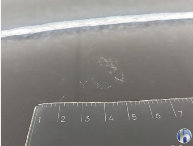
2. lakonthechting Beschadigd - Spuiten
