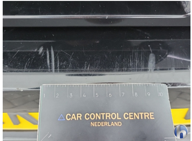
1. Achterbumper Gebruikssporen - Aanvaardbaar
