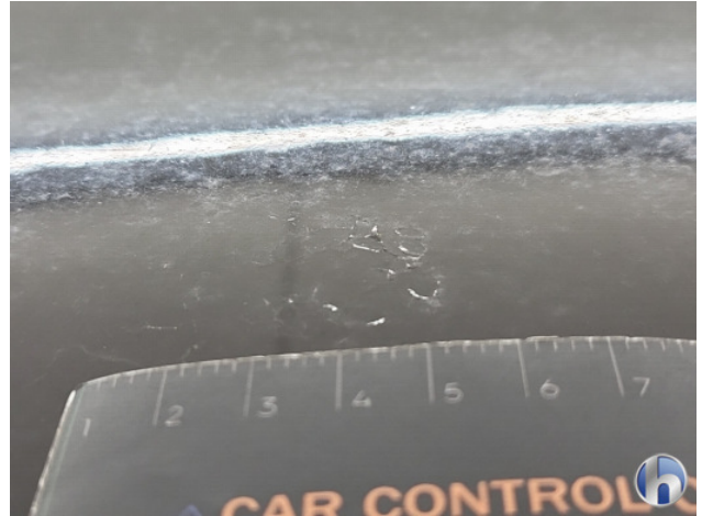
2. lakonthechting Beschadigd - Spuiten
