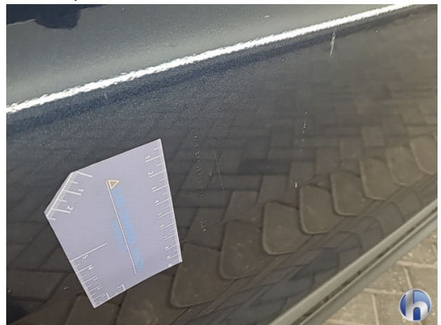
1. Diverse Gebruikssporen - Aanvaardbaar
