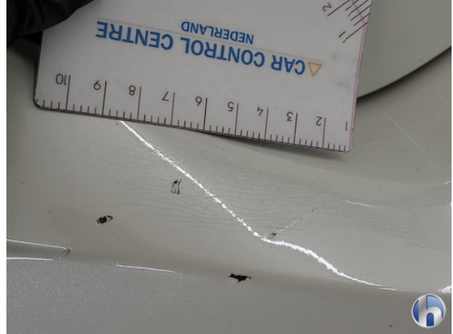
1. Achterbumper Deuk/deuken - Spot Repair/Deelreparatie
