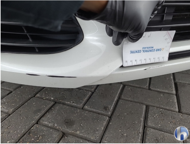
2. Voorbumper Krassen - Spot Repair/Deelreparatie
