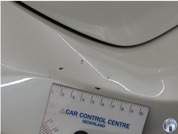
1. Achterbumper Deuk/deuken - Spot Repair/Deelreparatie
