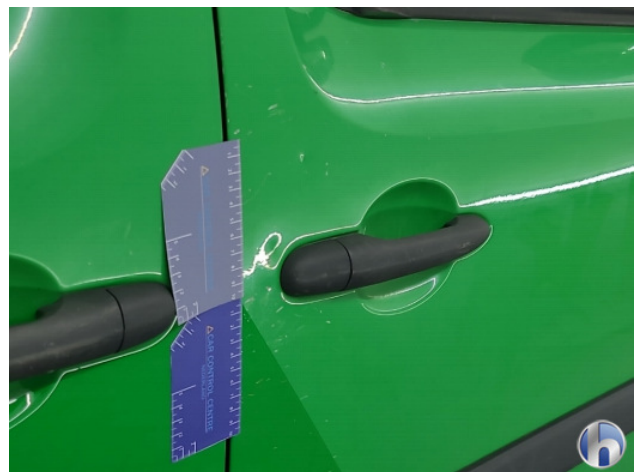
5. Portier voor - rechts Deuk/deuken - Herstellen
