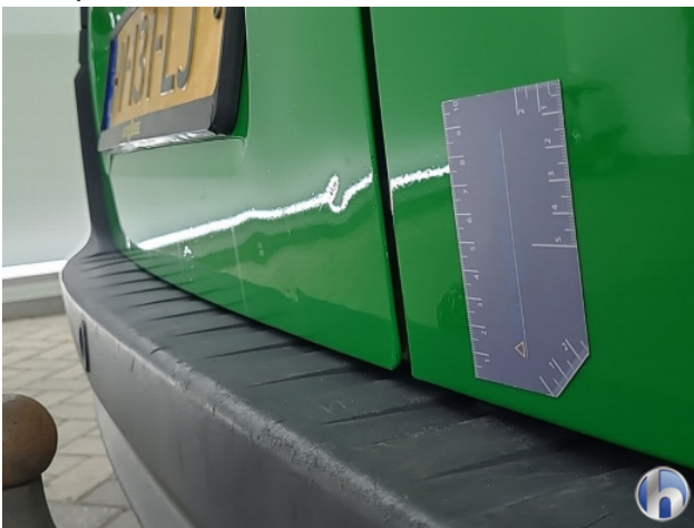
3. Achterklep Deuk/deuken - Aanvaardbaar
