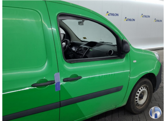
5. Portier voor - rechts Deuk/deuken - Herstellen
