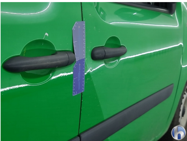
5. Portier voor - rechts Deuk/deuken - Herstellen
