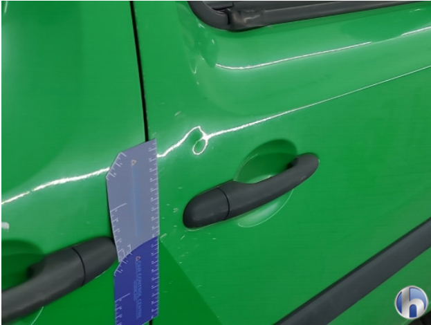
5. Portier voor - rechts Deuk/deuken - Herstellen
