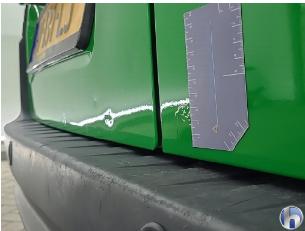
3. Achterklep Deuk/deuken - Aanvaardbaar
