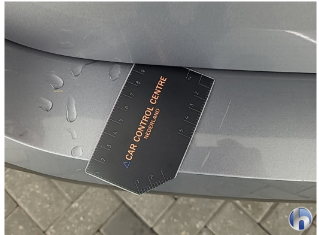
1. diverse schades Gebruikssporen - Aanvaardbaar
