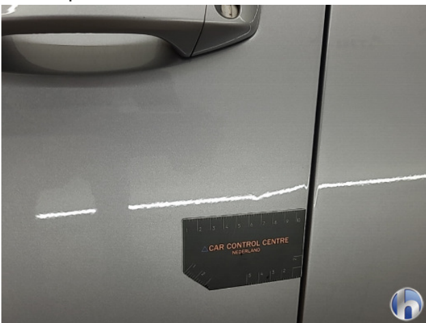
1. diverse schades Gebruikssporen - Aanvaardbaar
