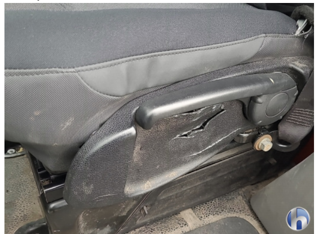
3. Diverse Interieurdelen Beschadigd - Vernieuwen
