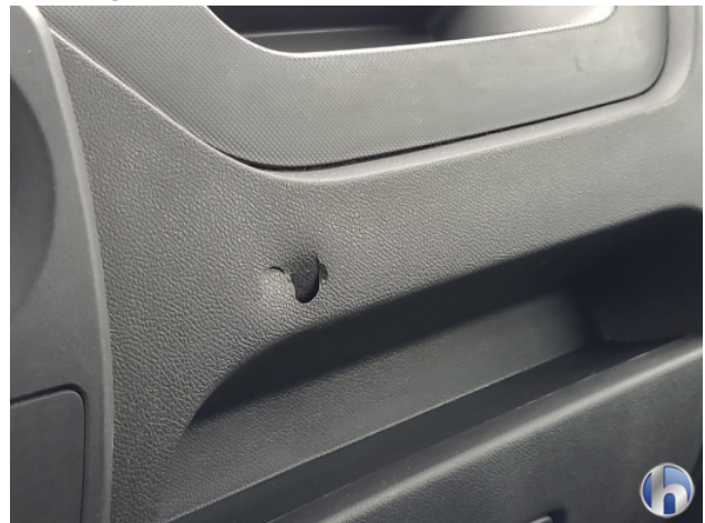
3. Diverse Interieurdelen Beschadigd - Vernieuwen
