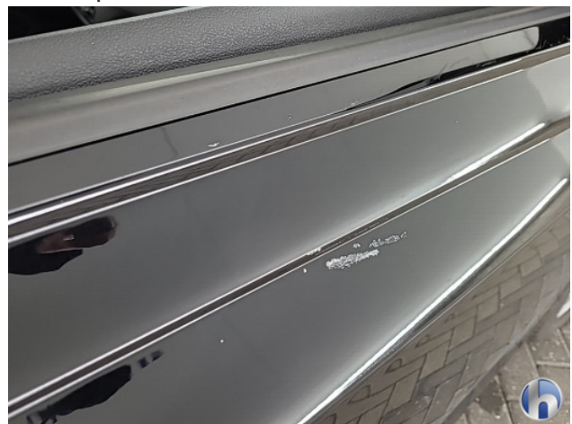
1. Ontstickerresten Gebruikssporen - Aanvaardbaar
