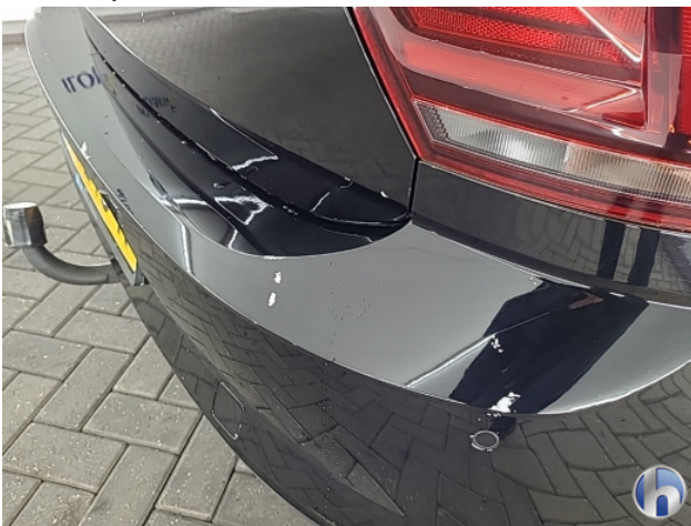
1. Ontstickerresten Gebruikssporen - Aanvaardbaar
