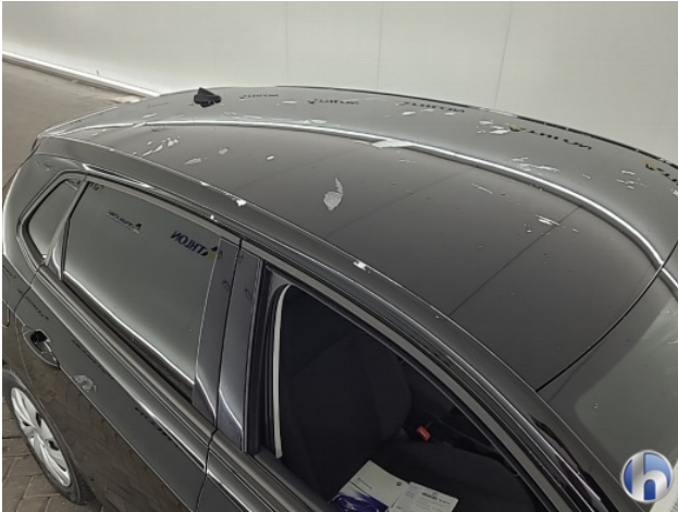
1. Ontstickerresten Gebruikssporen - Aanvaardbaar
