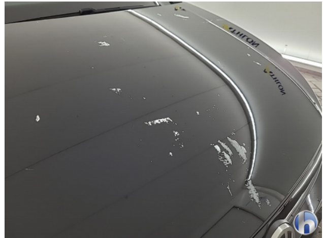
1. Ontstickerresten Gebruikssporen - Aanvaardbaar
