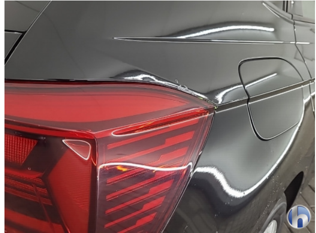
1. Ontstickerresten Gebruikssporen - Aanvaardbaar
