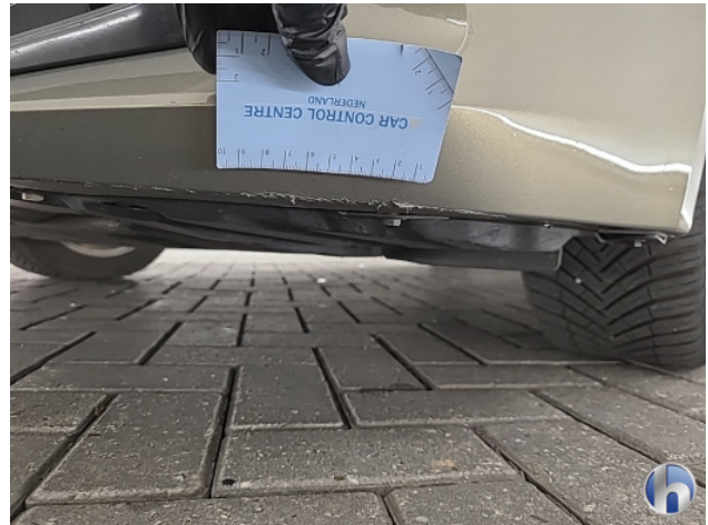
1. diverse Gebruikssporen - Aanvaardbaar
