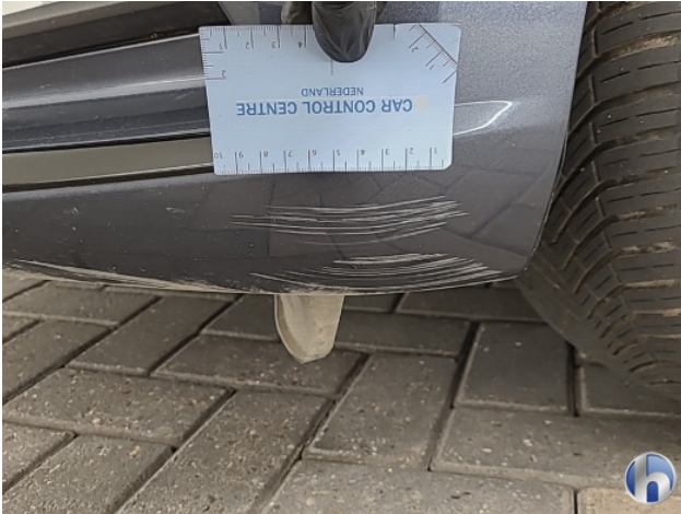
1. diverse Gebruikssporen - Aanvaardbaar
