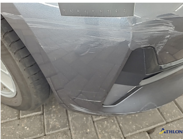
1. diverse schades Gebruikssporen
