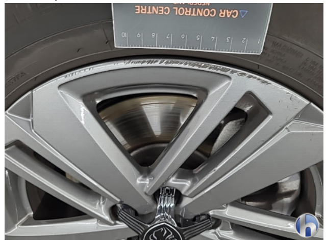
1. diverse schades Gebruikssporen - Aanvaardbaar
