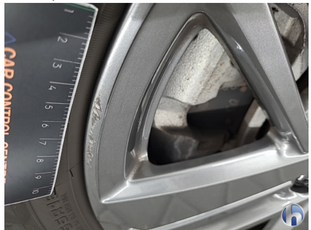
1. diverse schades Gebruikssporen - Aanvaardbaar
