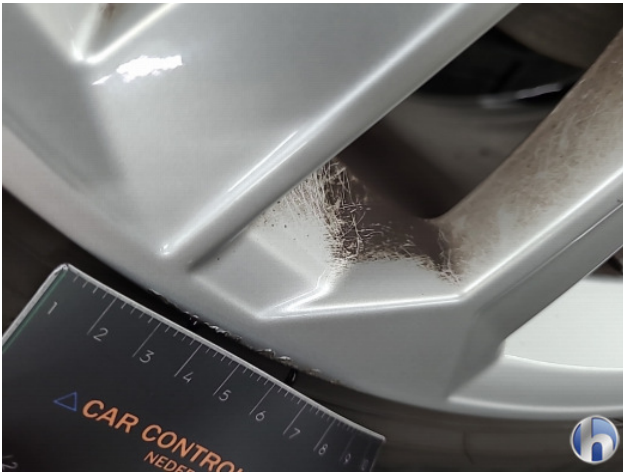
1. diverse schades Gebruikssporen - Aanvaardbaar
