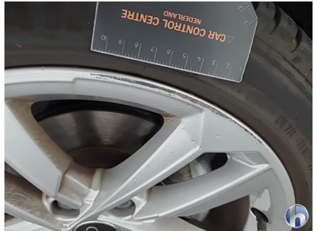
1. diverse schades Gebruikssporen - Aanvaardbaar
