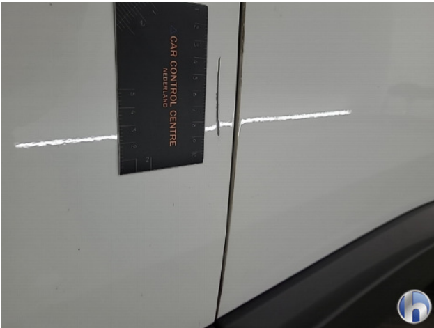
1. Portier voor - links Deuk/deuken - Herstellen
