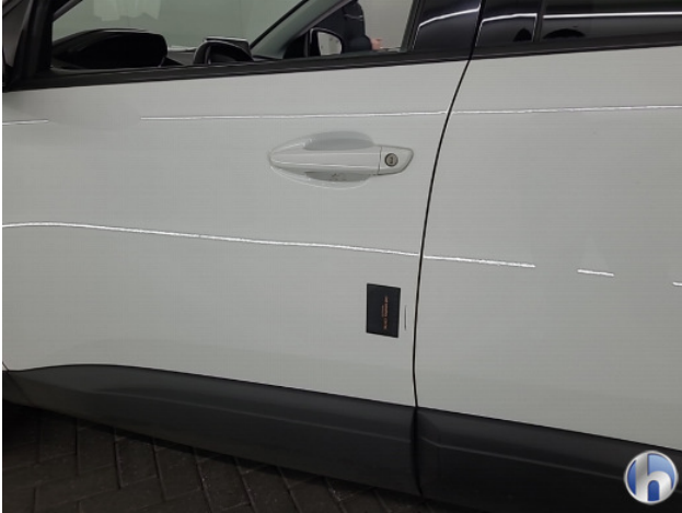
1. Portier voor - links Deuk/deuken - Herstellen
