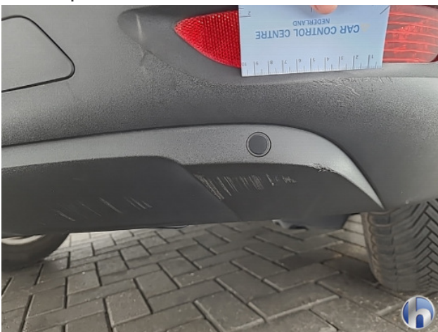
2. Achterbumper Gebruikssporen - Aanvaardbaar
