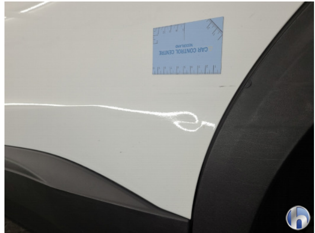
1. Portier achter - links Deuk/deuken - Herstellen
