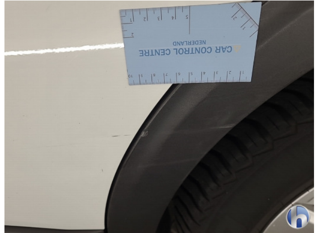
1. Portier achter - links Deuk/deuken - Herstellen
