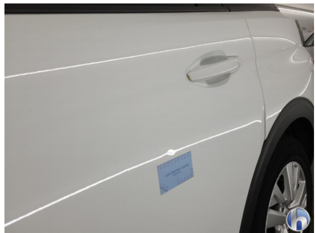
1. Portier achter - links Deuk/deuken - Herstellen
