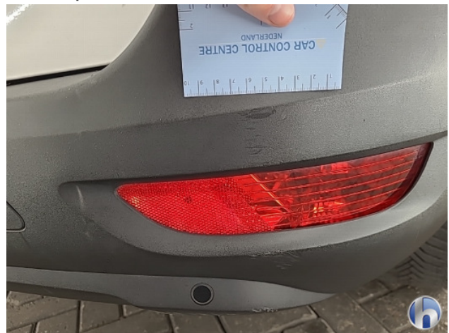
2. Achterbumper Gebruikssporen - Aanvaardbaar
