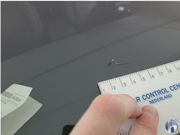
1. Voorruit Gebruikssporen - Aanvaardbaar
