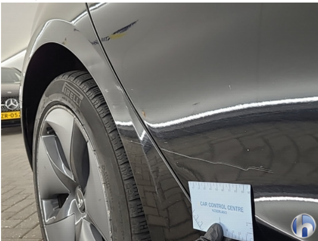
5. Portier achter - rechts Schaafplek - Herstellen
