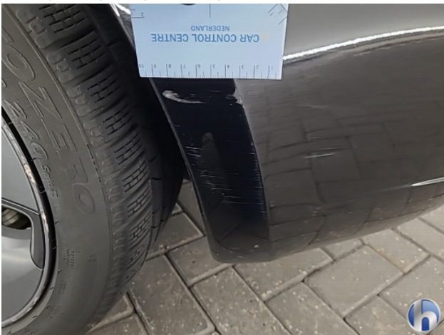
3. Achterbumper Schaafplek - Spot Repair/Deelreparatie
