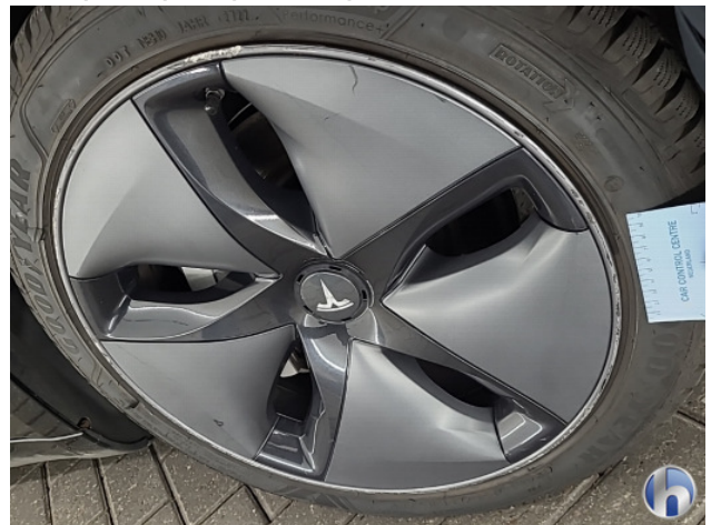
7. Diverse velgen Beschadigd - Herstellen
