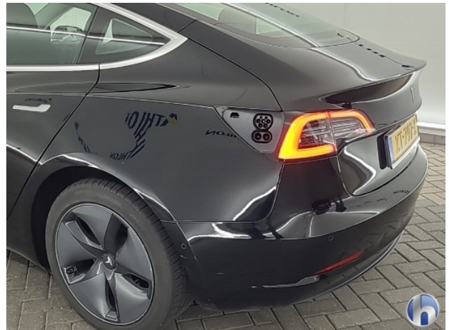
3. Achterbumper Schaafplek - Spot Repair/Deelreparatie
