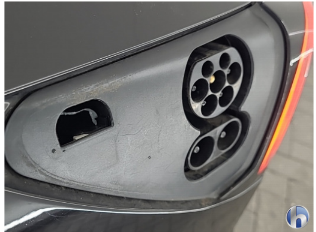
1. Laadklep afgebroken door wasstraat (intern) Gebruikssporen - Aanvaardbaar
