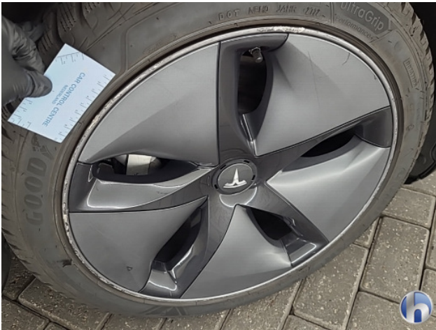
7. Diverse velgen Beschadigd - Herstellen
