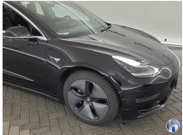
7. Diverse velgen Beschadigd - Herstellen
