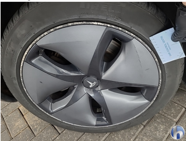
7. Diverse velgen Beschadigd - Herstellen
