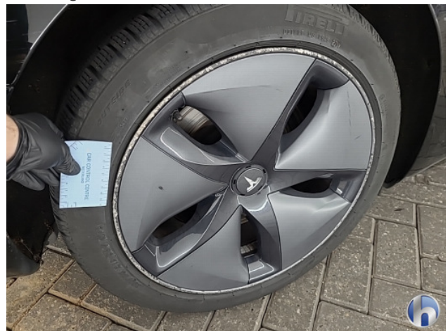
7. Diverse velgen Beschadigd - Herstellen
