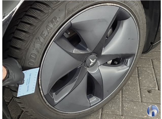
7. Diverse velgen Beschadigd - Herstellen
