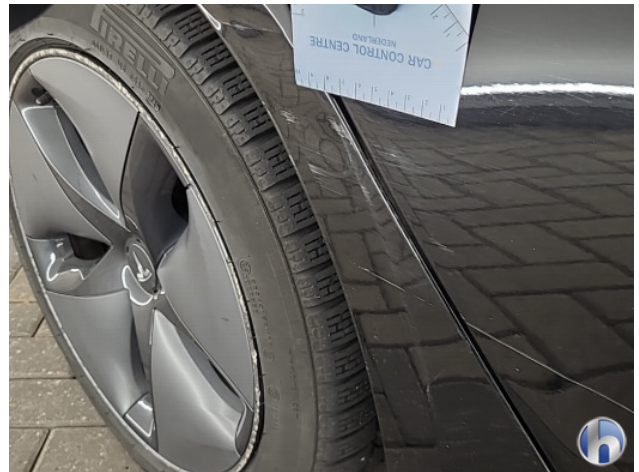
5. Portier achter - rechts Schaafplek - Herstellen
