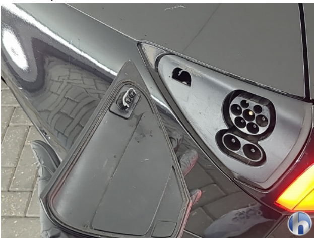
1. Laadklep afgebroken door wasstraat (intern) Gebruikssporen - Aanvaardbaar
