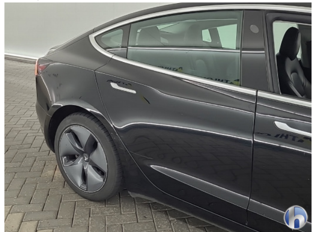
5. Portier achter - rechts Schaafplek - Herstellen
