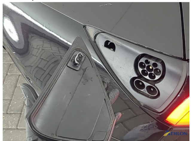
7. Laadklep afgebroken door wasstraat (intern) Gebruikssporen
