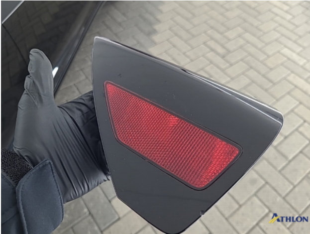
7. Laadklep afgebroken door wasstraat (intern) Gebruikssporen
