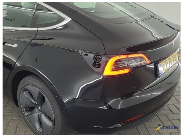
7. Laadklep afgebroken door wasstraat (intern) Gebruikssporen
