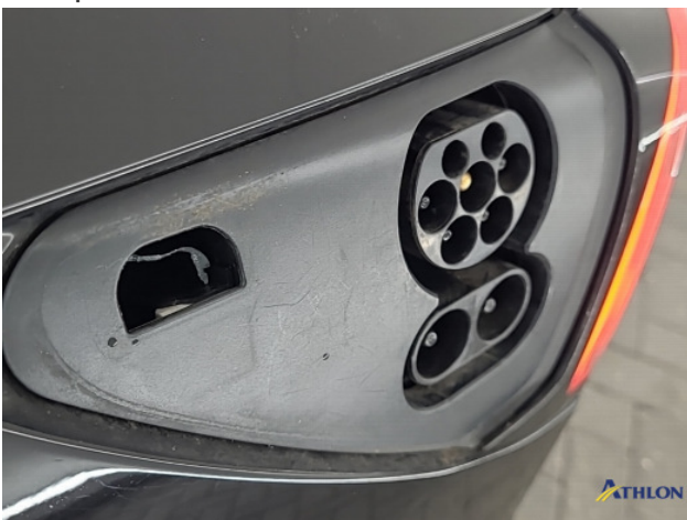
7. Laadklep afgebroken door wasstraat (intern) Gebruikssporen
