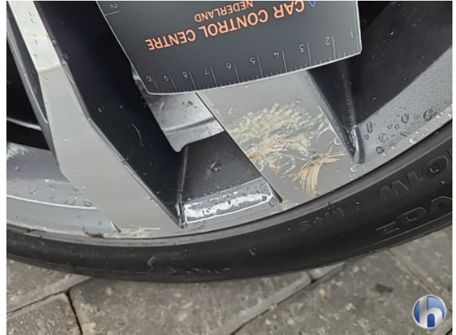
1. diverse schades Beschadigd - Aanvaardbaar
