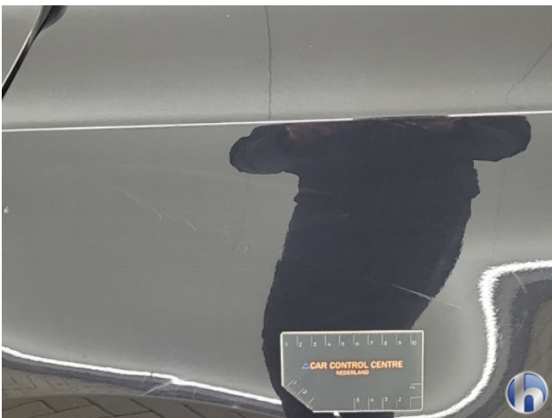
3. Zijwand - achter - Links Deuk/deuken - Herstellen
