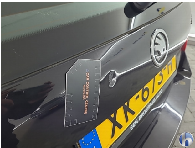
4. Achterklep Deuk/deuken - Herstellen
