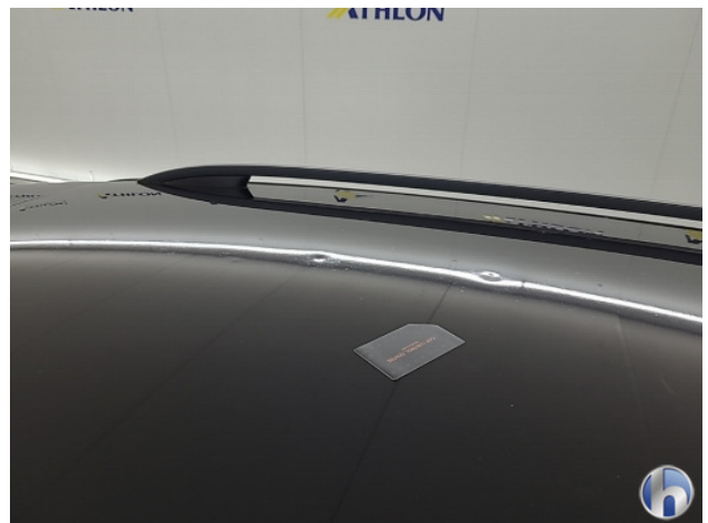
5. Dak Deuk/deuken - Herstellen zonder spuiten
