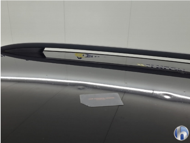
5. Dak Deuk/deuken - Herstellen zonder spuiten
