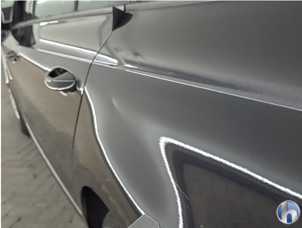
3. Zijwand - achter - Links Deuk/deuken - Herstellen
