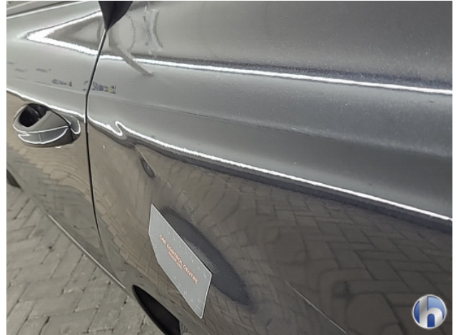
3. Zijwand - achter - Links Deuk/deuken - Herstellen
