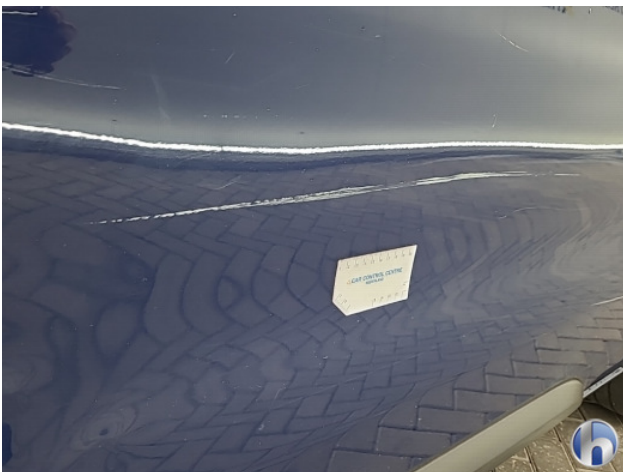
1. Zijwand - achter - Links Deuk/deuken - Herstellen
