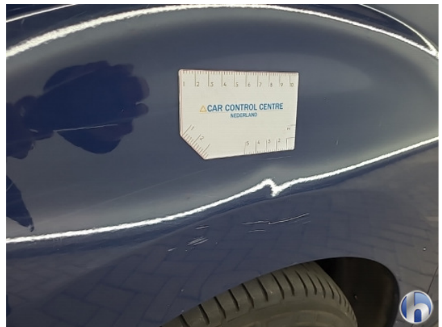
1. Zijwand - achter - Links Deuk/deuken - Herstellen
