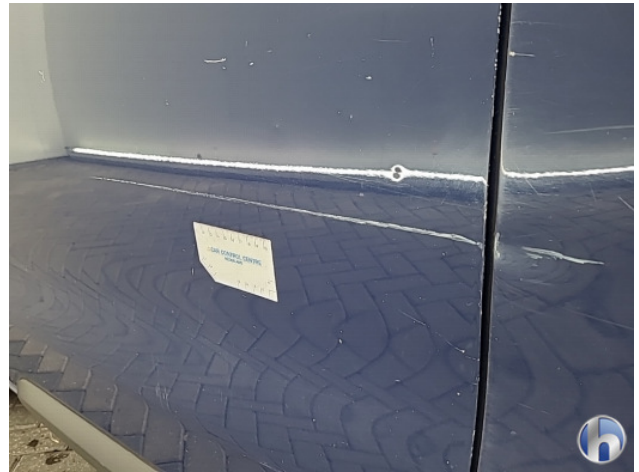
1. Zijwand - achter - Links Deuk/deuken - Herstellen
