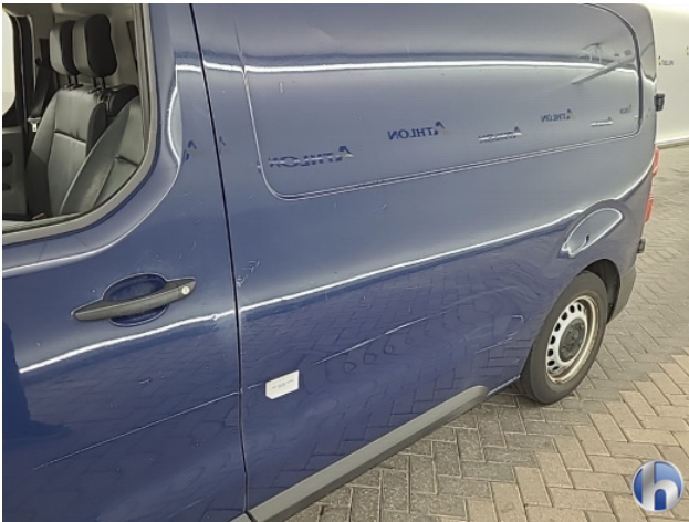
1. Zijwand - achter - Links Deuk/deuken - Herstellen
