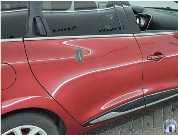
2. lakonthechting Beschadigd - Spuiten
