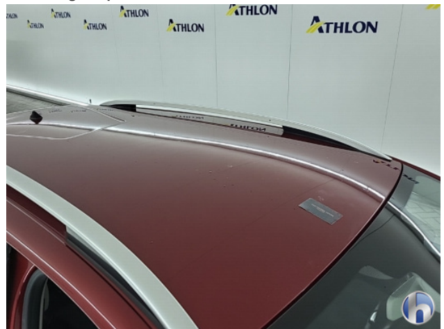
2. lakonthechting Beschadigd - Spuiten
