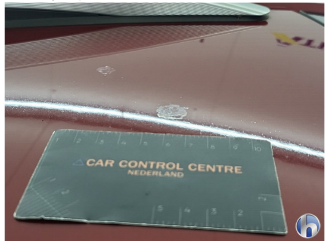
2. lakonthechting Beschadigd - Spuiten
