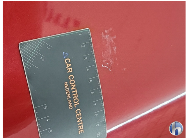
2. lakonthechting Beschadigd - Spuiten
