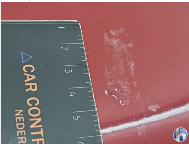
2. lakonthechting Beschadigd - Spuiten
