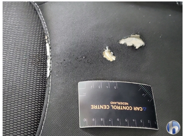
4. diverse interieur Beschadigd - Herstellen
