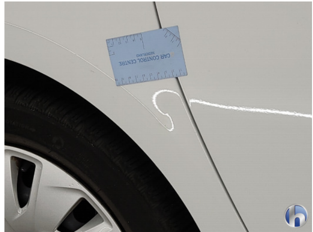
2. Zijwand - achter - rechts Deuk/deuken - Herstellen zonder spuiten
