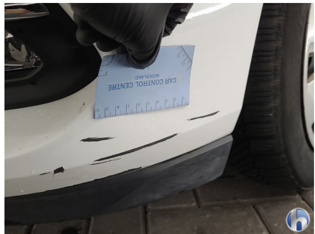
4. Voorbumper Schaafplek - Spot Repair/Deelreparatie
