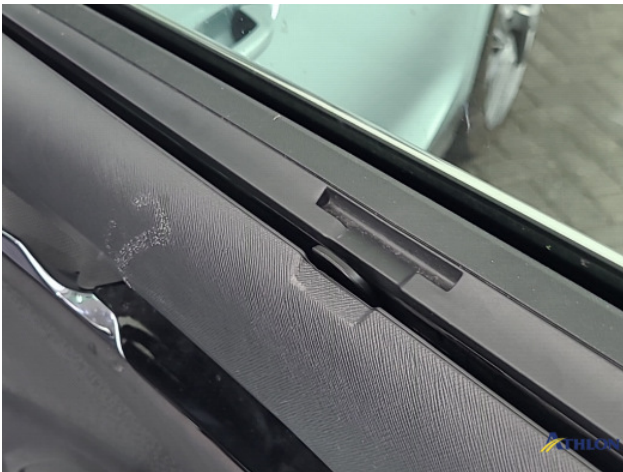
3. privacy scherm RA defect Gebruikssporen
