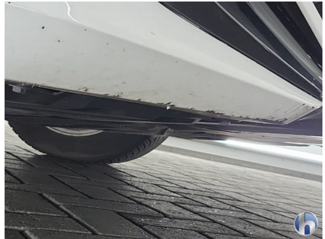
1. diverse Gebruikssporen - Aanvaardbaar
