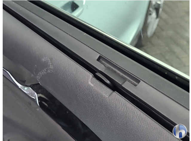
3. privacy scherm RA defect Gebruikssporen - Aanvaardbaar
