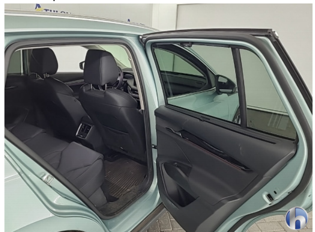
3. privacy scherm RA defect Gebruikssporen - Aanvaardbaar
