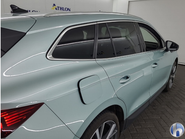
1. laadpoort drukveer (klep sluit niet af) Gebruikssporen - Aanvaardbaar
