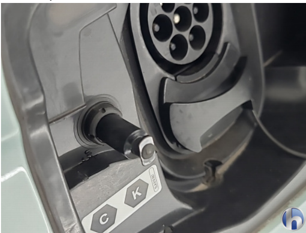
1. laadpoort drukveer (klep sluit niet af) Gebruikssporen - Aanvaardbaar
