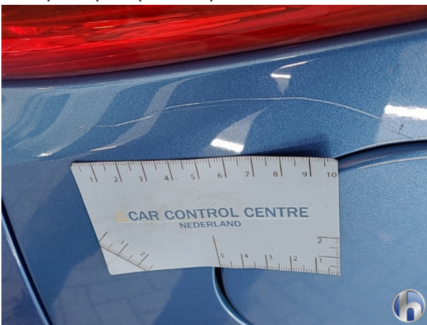
2. Achterbumper Schaafplek - Spot Repair/Deelreparatie
