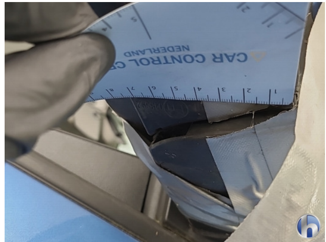
5. Spiegelbehuizing - rechts Breuk / barst / scheur - Vernieuwen
