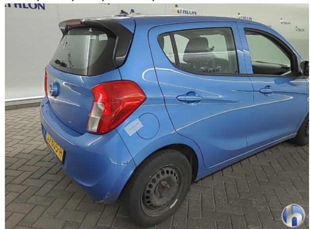
2. Achterbumper Schaafplek - Spot Repair/Deelreparatie
