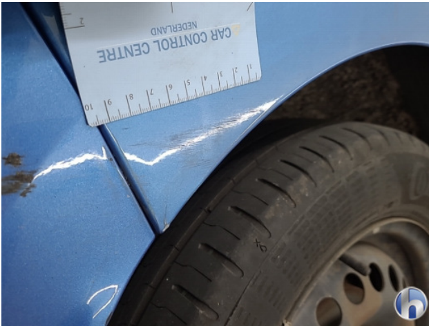
2. Achterbumper Schaafplek - Spot Repair/Deelreparatie
