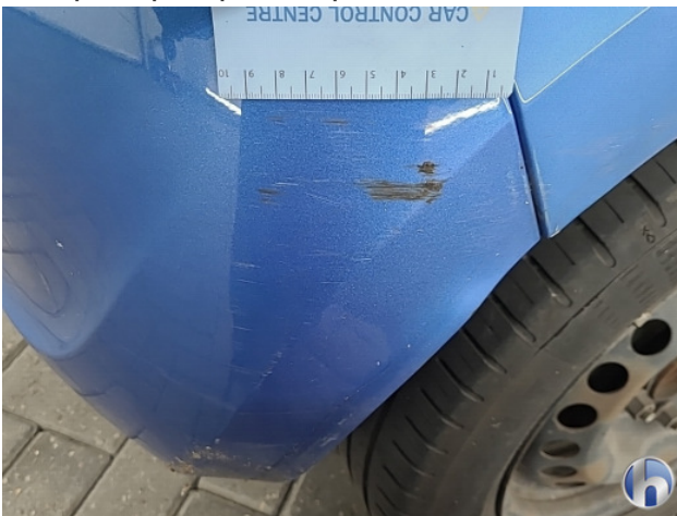
2. Achterbumper Schaafplek - Spot Repair/Deelreparatie
