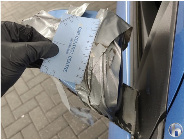
5. Spiegelbehuizing - rechts Breuk / barst / scheur - Vernieuwen
