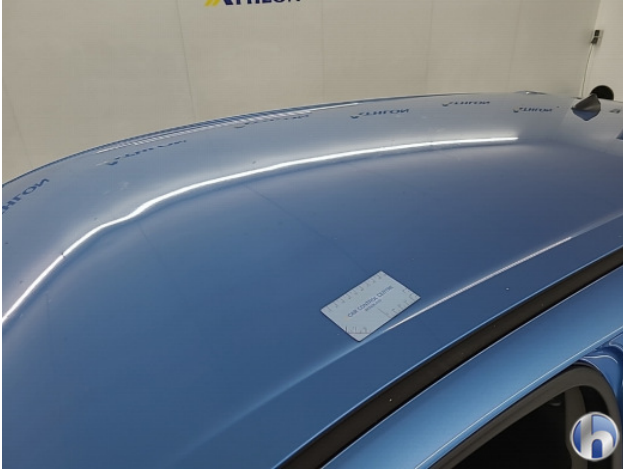
1. Dak Deuk/deuken - Herstellen zonder spuiten
