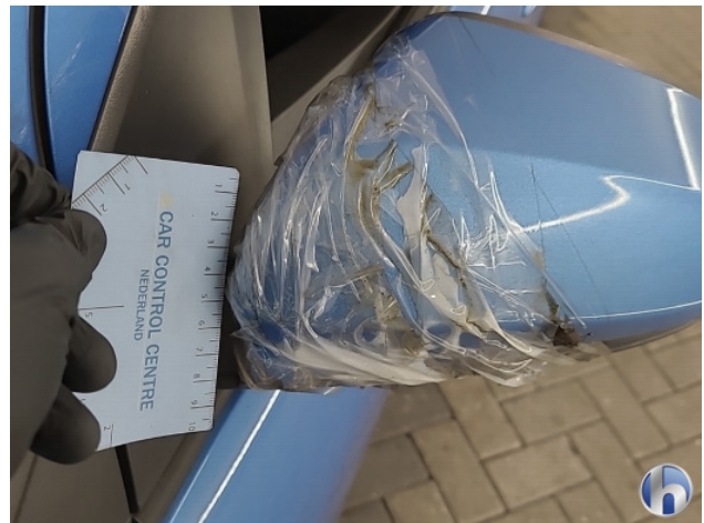
4. Spiegelbehuizing - links Breuk / barst / scheur - Vernieuwen
