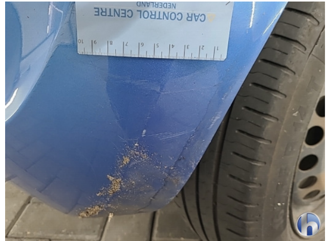
2. Achterbumper Schaafplek - Spot Repair/Deelreparatie
