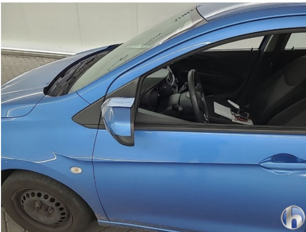
4. Spiegelbehuizing - links Breuk / barst / scheur - Vernieuwen
