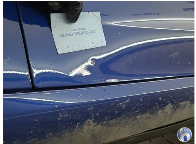
1. Portier voor - links Deuk/deuken - Herstellen
