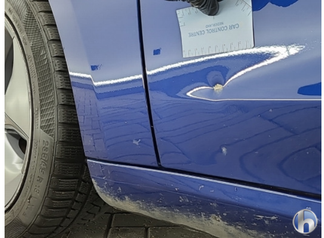
1. Portier voor - links Deuk/deuken - Herstellen
