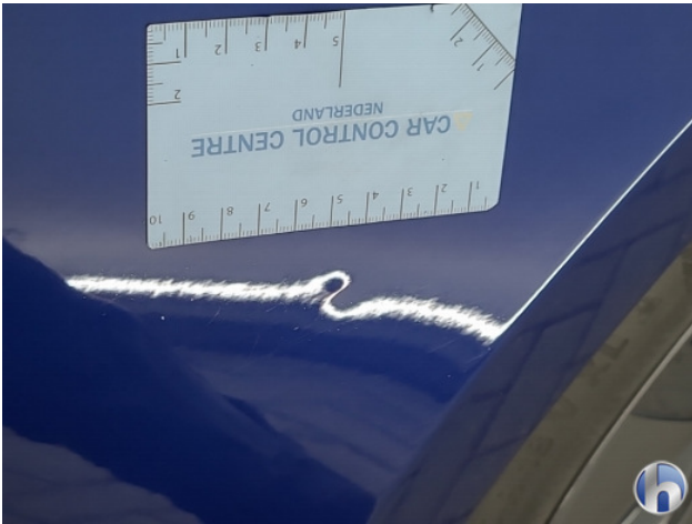
2. diverse Gebruikssporen - Aanvaardbaar
