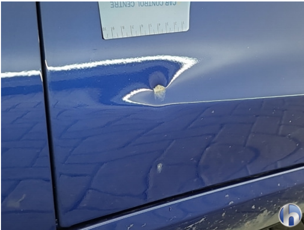
1. Portier voor - links Deuk/deuken - Herstellen
