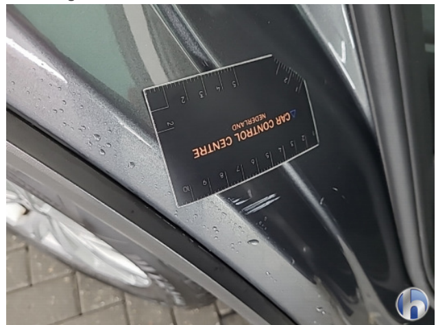
1. diverse schades Beschadigd - Aanvaardbaar
