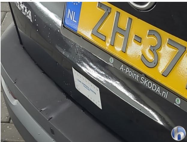
1. Slecht Herstel Gebruikssporen - Aanvaardbaar
