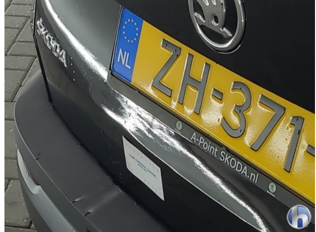
1. Slecht Herstel Gebruikssporen - Aanvaardbaar
